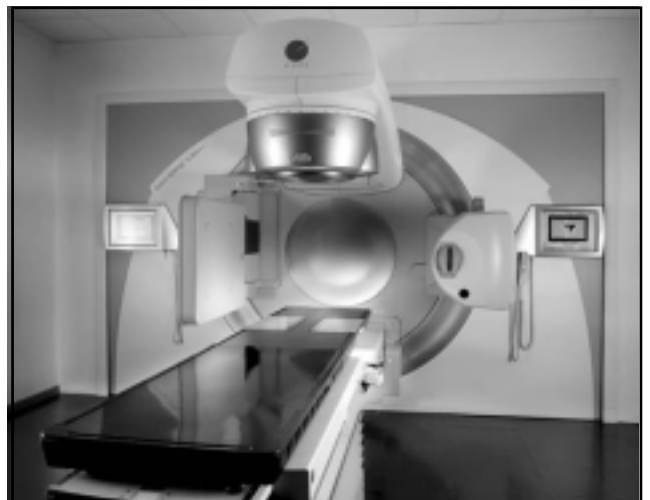
Fig. 2. El Synergy S (Elekta, Inc., Atlanta, Georgia) combina un acelerador lineal con un sistema de imagen de volumen de 3D totalmente incorporado que permite que el área de tratamiento exacta se visualice en el momento preciso del tratamiento mientras el paciente se encuentra listo en la camilla. Luego, la camilla realiza de forma automática los ajustes necesarios en la posición del paciente con el fin de asegurar que se dirija la radiación de manera precisa.
