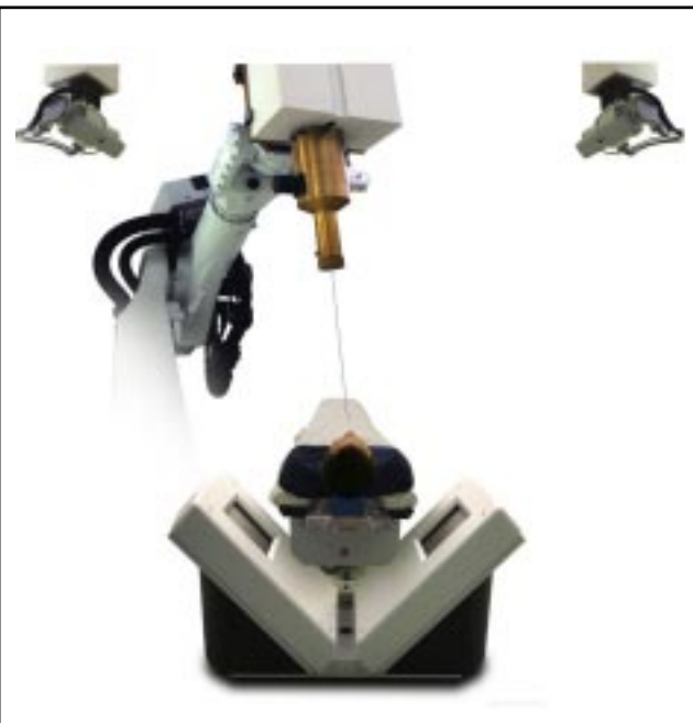
Fig. 1. El CyberKnife radiosurgical system (Accuray, Inc., Sunnyvale, California). Nótese las dos pantallas de silicón amorfa colocadas ortogonalmente a la camilla de tratamiento. La camilla puede moverse para posicionar los puntos de referencia delante de las cámaras. Se detecta una referencia radiográfica con la ayuda de guía por imagen en tiempo real. Se comunica a través de un aro de control en tiempo real la posición medida como se ve en las dos cámaras a un manipulador robotizado que dirige el haz al objetivo exacto.
