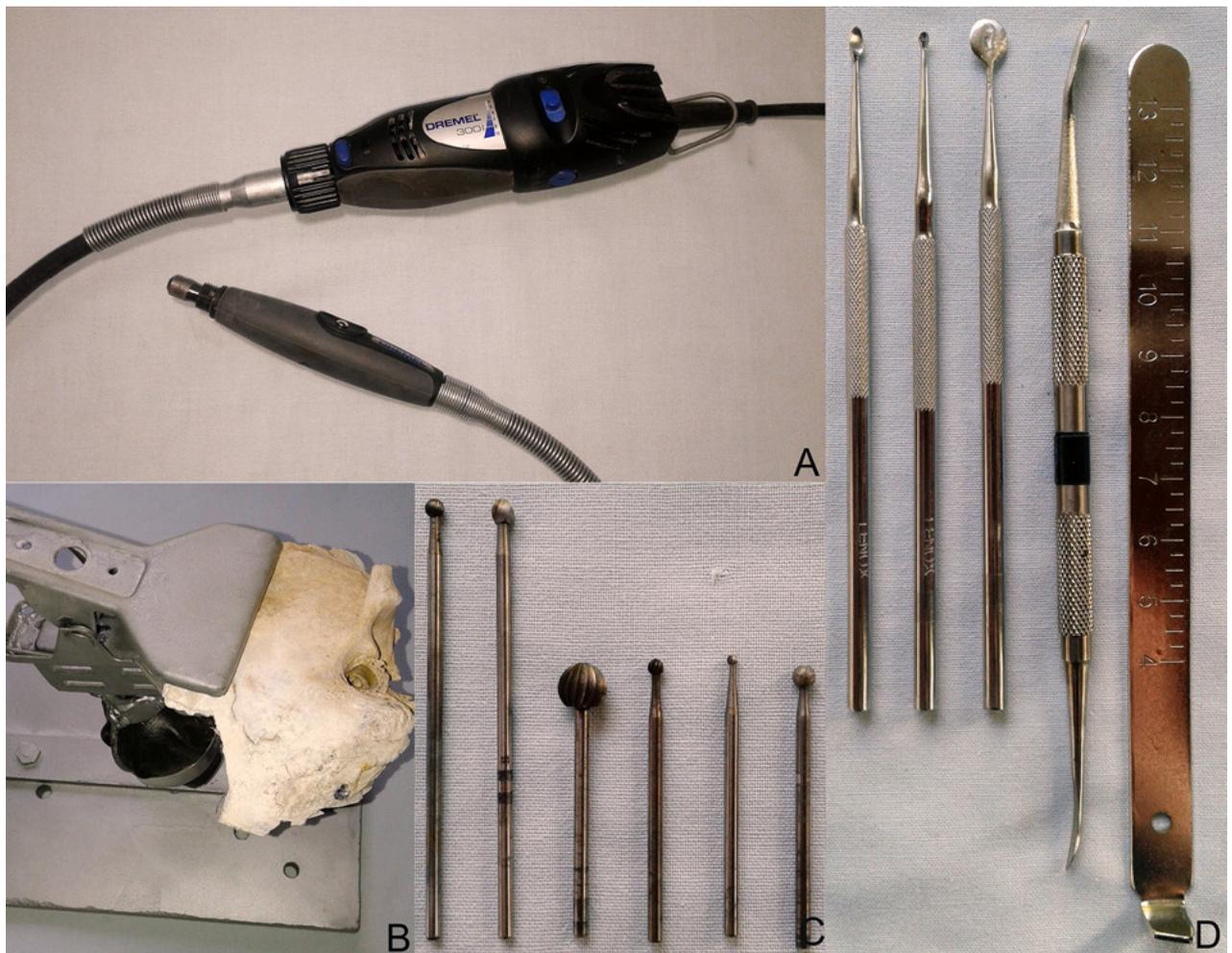
Figura 2: A) Minitornillo con eje flexible, obtenido en ferretería. El mismo se conectaba a un pedal de control de encendido. B) Sostén y fijación de huesos. C) Fresas utilizadas, con diferente longitud de vástago y diámetro. Las últimas dos, diamantadas. D) Curetas, disectores y separador malleable.
